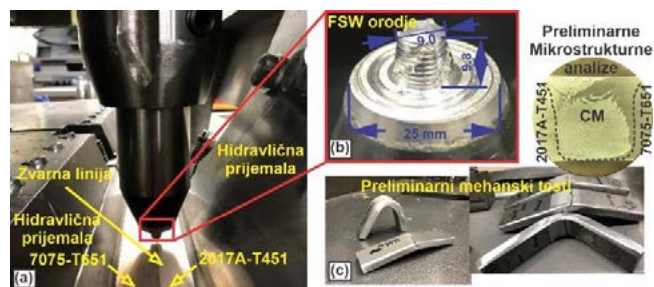
Slika 2: Prikaz procesa FSW (a); orodja (b) ter preliminarni testi za izbor parametrov varjenja (c).
