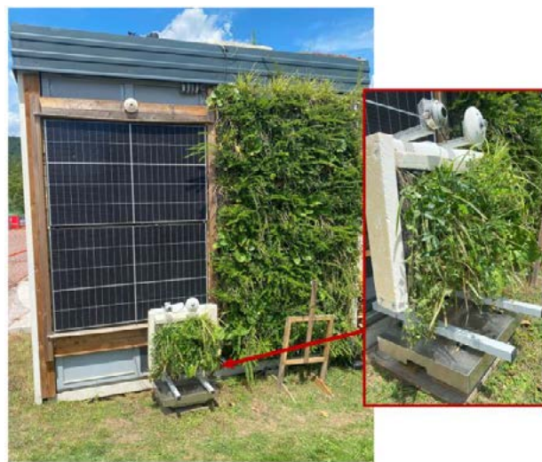
Slika 1: Zunanje preskuševališče LOTZ v Gamelnah z ozelenjeno steno sistema Urbanscape® (levo) in modul ozelenjene stene na tehnični za določanje urne ET (desno).
