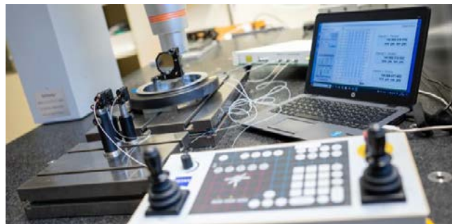
Slika 2: Tri-kanalni diodni laserski interferometer Picoscale.
