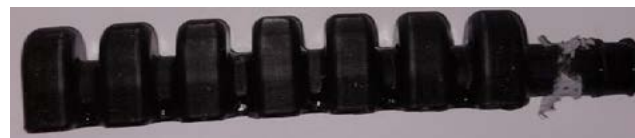
Slika 2: Tri-dimenzionalno, s SLA natisnjena oblika prijemala [3].
