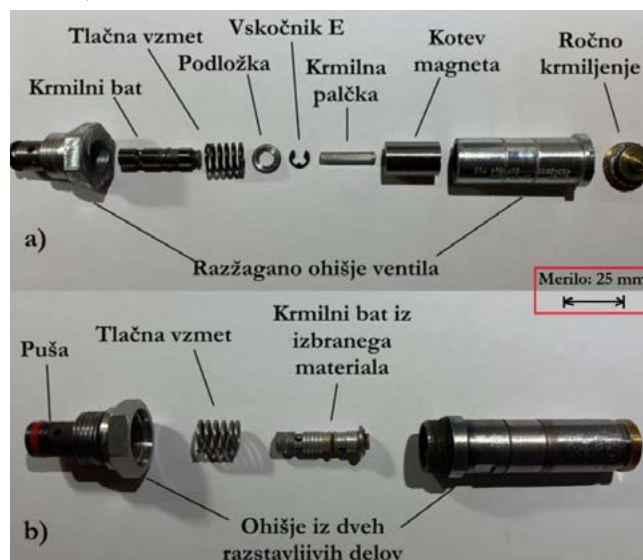
Slika 1: (a) Razžagan ventil EVH2C; (b) Predelan ventil.
