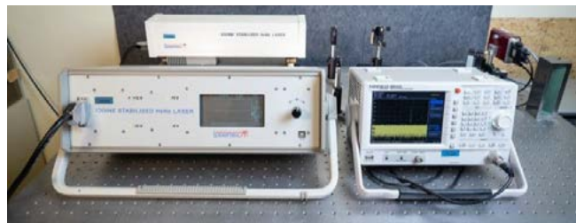
Slika 3: Prikaz primerjalnega umerjanja LI.
