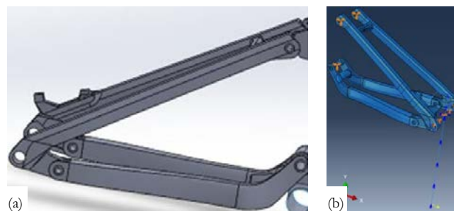
Slika 2: (a) Geometrijski model zadnjega dela okvirja gorskega kolesa in (b) modeliranje platišča, pritrditve zavorne čeljusti in vnos robnih pogojev.
