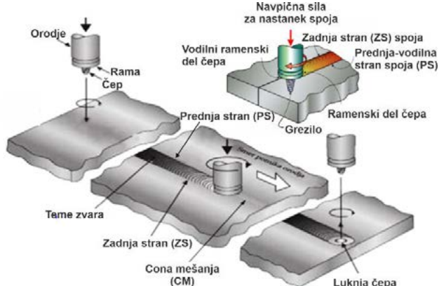
Slika 1: Shematski prikaz FSW varjenja [5].
