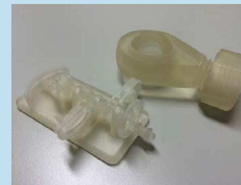
Izdelava različnih delujočih mehanizmov, saj je podporni material vosek, ki se po obdelavi stopi na temperaturi 60° in tako dobimo izdelke že z vsemi zelenimi sestavi.
