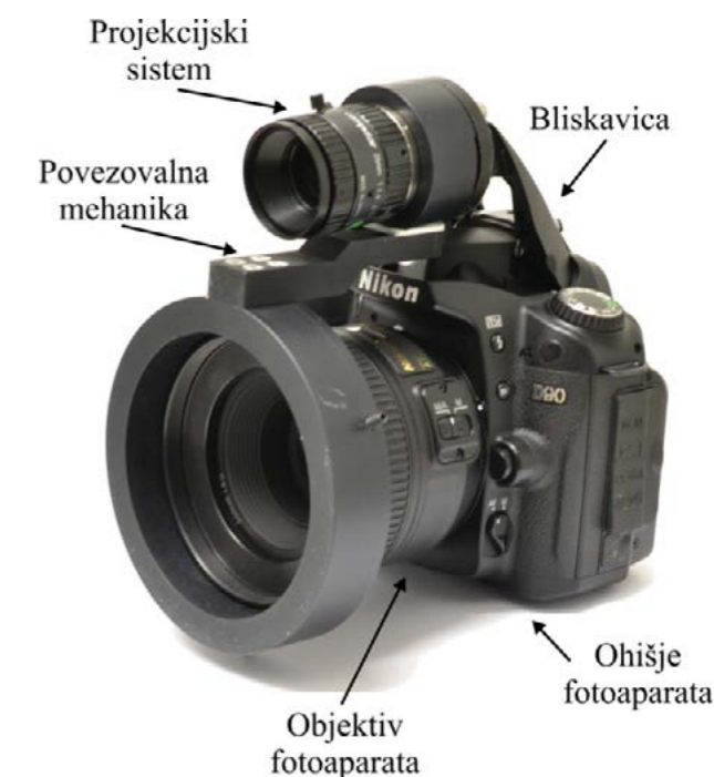
Slika 1: Glavni sestavni deli ročnega 3D merilnika.
